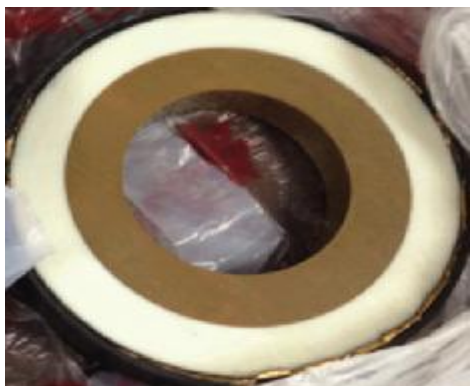
图 8 硅橡胶挤包绝缘母线(实物切片)
